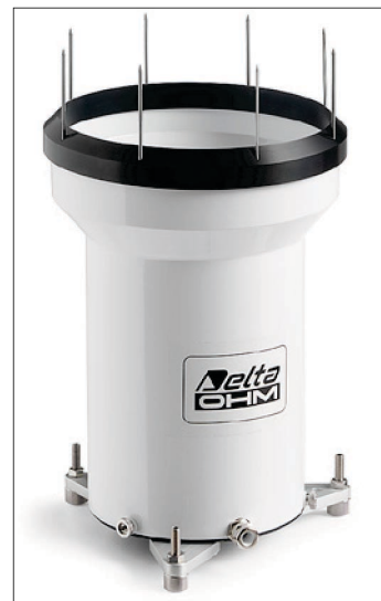
Pluviómetro con el disuasor para pájaros.
