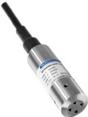
MPM489W es un transmisor de nivel sumergible completamente sellado. Está fabricado con un sensor de presión OEM altamente estable y confiable y una placa de circuito de alta precisión en la carcasa de acero inoxidable.
